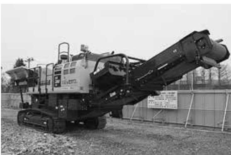
施設内に用意されている移動式石材破砕機「ガラバゴス」
