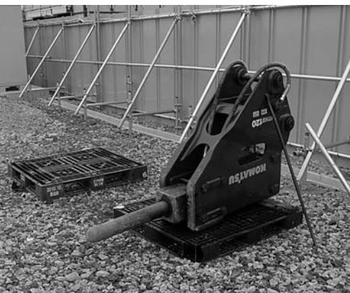
【2点】新調したコマツ製の油圧ショベル（上）と小割用のブレイカー（左）。用途に応じてショベルの先を付け替えて使用する。ブレイカー先端の刃も定期的な交換が必要となる消耗品で、その交換費用だけで100万円以上かかるとされる
