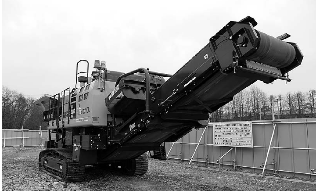
同社の石材リサイクル処理施設に配備されたコマツ製の自走式破砕機「ガラパゴス BR380JG-1」
