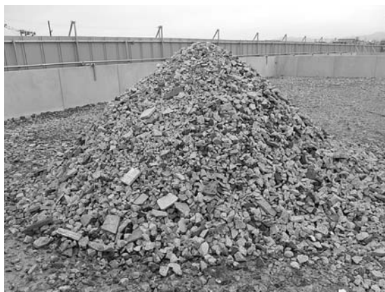
小割(一次破碎)した石材をガラパゴスに投入すると、この大きさになって出てくる。公共工事等に使う場合はさらに篩いにかけて、再生砕石として出荷する
